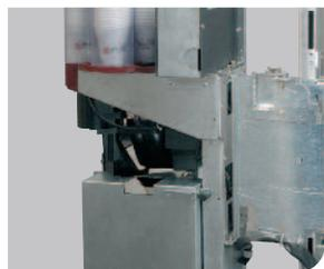
Distribuidor de vasos con apertura doble para una completa articulación del conjunto, facilita el acceso a la parte interior de la máquina en las operaciones de carga, mantenimiento y limpieza
